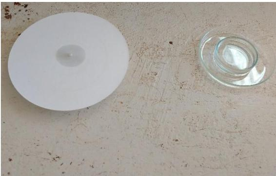
**FIGURA 2.2** – Impregnação com solução de  $\text{AgNO}_3$  a 0,5%.
