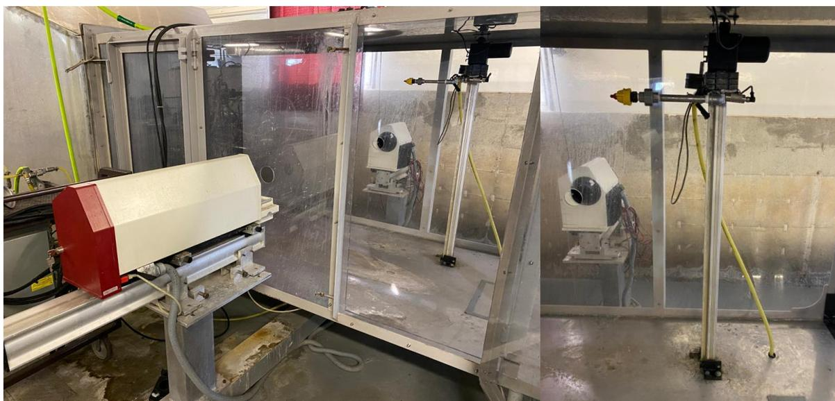
**Figura 2.** Sistema utilizado para a análise de espectro de gotas das técnicas de aplicação estudadas.
