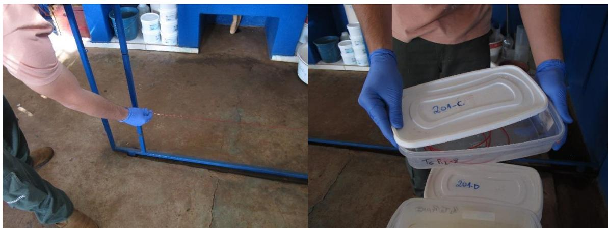
**Figura 5.** A) Disposição dos suportes e fixação dos fios de polietileno em diferentes alturas verticais. B) Recipiente de armazenamento e lavagem dos coletores, devidamente identificados.
