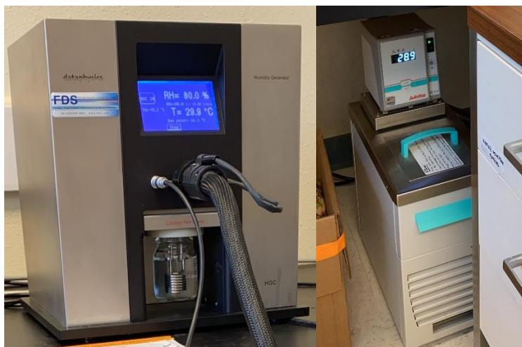
**Figura 4 -** Equipamentos para controle de temperatura e umidade.
