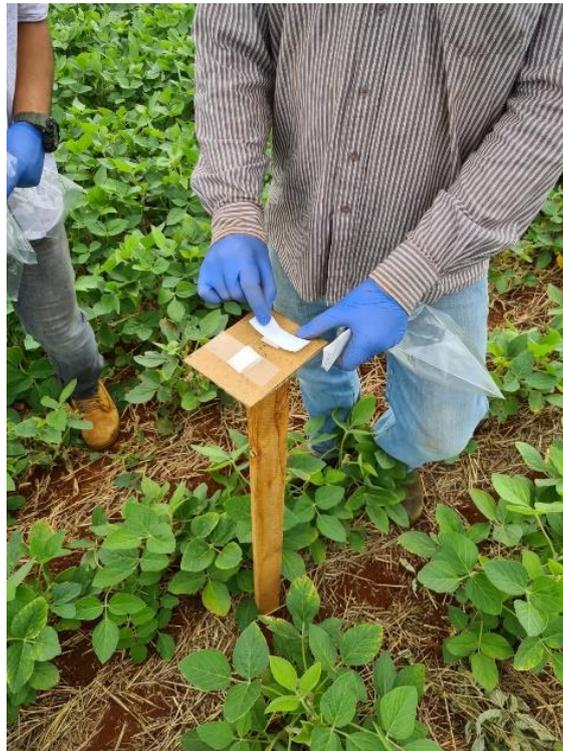
**Figura 2.9.** Coletores de depósito e cobertura sob a superfície a 0,90 m do solo. Foto: Silva, A.S. (2022).
