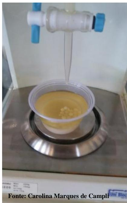
**Figura 4.** Formação de gotas na extremidade da bureta.
