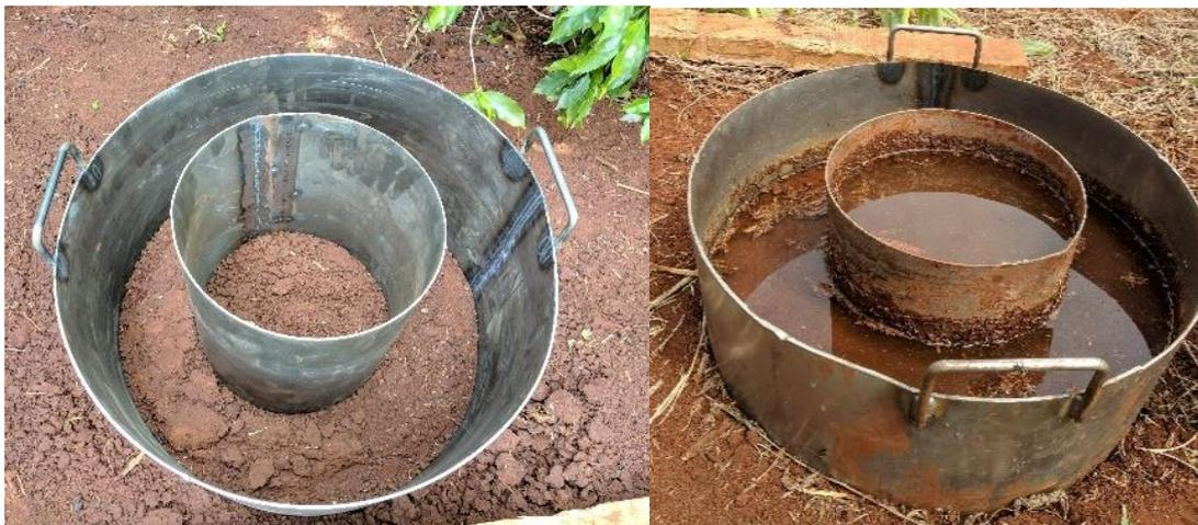
Após a leitura inicial da altura da água com a régua graduada, iniciou-se a contagem do tempo para infiltração da água no solo. Com auxílio de cronometro foram obtidos os tempos, as leituras da altura da água foram realizadas no interior do anel menor com intervalo de tempo de minuto a minuto até 10, a cada 5 minutos até 30, a cada 10 minutos até 60, e por fim intervalo de 30 minutos até os 180 minutos.
