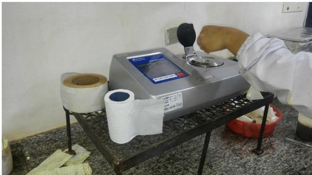
**Figura 7.** Amostra em refratômetro digital. Foto: Teodoro (2017).
