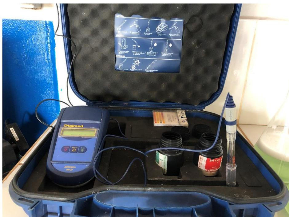
**Figura 10** - Equipamento pHmetro modelo digimed-DM-3P. **Foto:** NITEC/UENP, Bandeirantes/PR.
