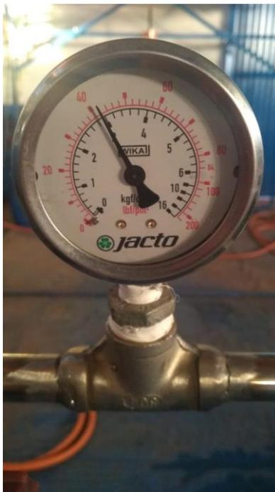
**Figura 8-** Manômetro da barra de pulverização registrando a pressão de 43,5 PSI. Foto: NITEC/UENP, Bandeirantes/PR.
