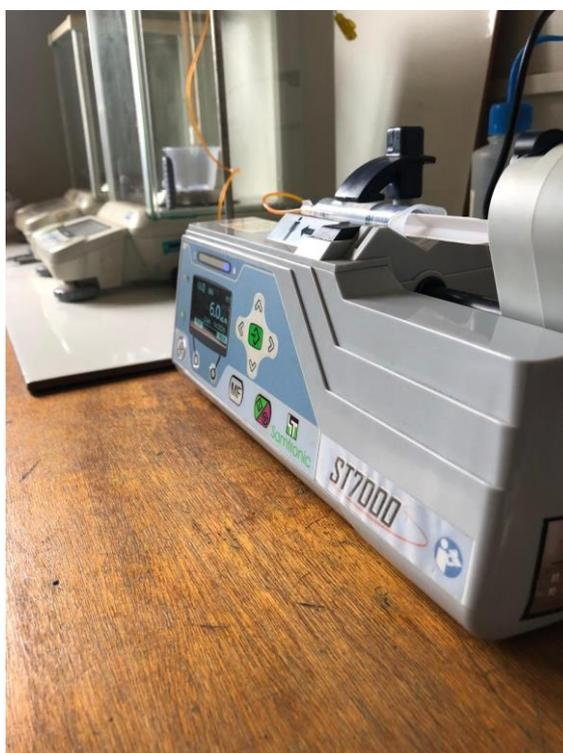
**Figura 11** - Bomba de infusão modelo Samtronic ST7000 com fluxo de  $6 \text{ mL h}^{-1}$ , utilizada para realização da tensão superficial. **Foto:** NITEC/UENP, Bandeirantes/PR.
