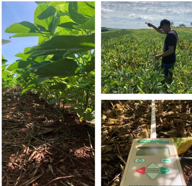
**Figura 19** – Sombreamento e análise do índice de área foliar, realizada pelo ceptômetro do modelo ACCUPAR LP-80. Foto: CUNHA, W.A.B BANDEIRANTES/PR
