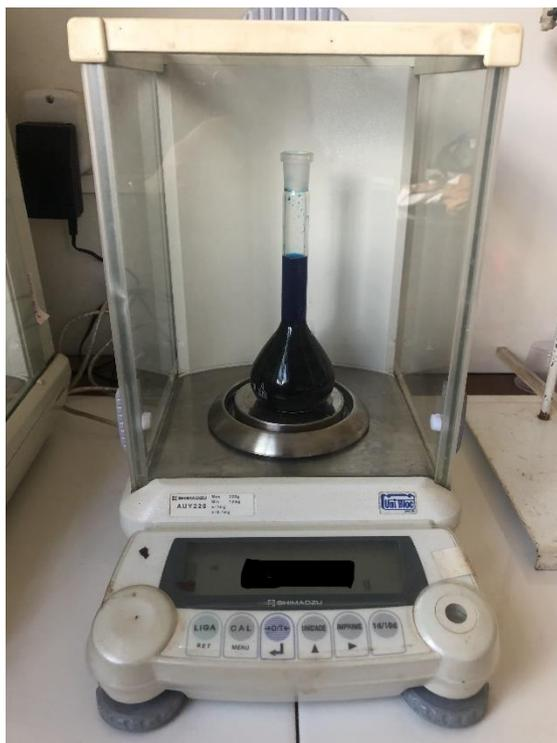
**Figura 8** – Balança de precisão (0,0001), Balões volumétricos (100 mL). Foto: CUNHA, W.A.B Bandeirantes/PR.
