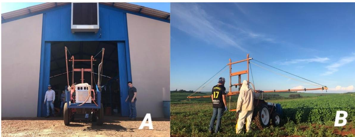
**Figura 13** - A: Trator marca Agrale 4100<sup>®</sup> B: Barra de pulverização com 13 porta bicos. Foto: CUNHA, W.A.B. BANDEIRANTES/PR
