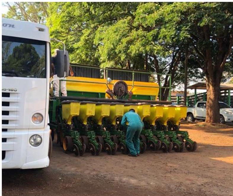
**Figura 11** – Regulagem de semeadora. Foto: CUNHA, W.A.B BANDEIRANTES/PR
