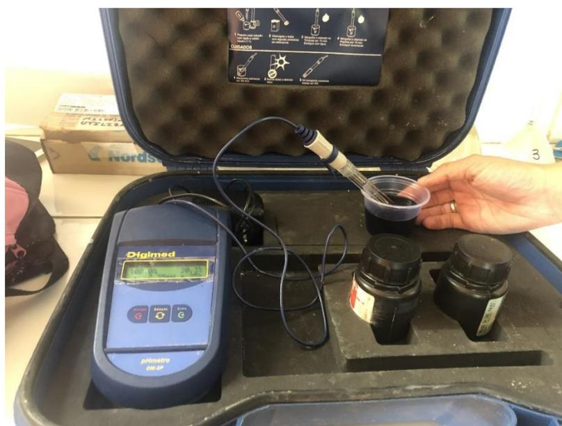
**Figura 6** – Equipamento e medição pHmetro modelo digimed-DM-3P. Foto: CUNHA, W.A.B Bandeirantes/PR.
